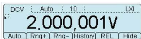
真の6½桁読み取り分解能 (DM3068)
